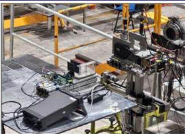
(बायें) CERN की सुपर प्रोटोन सिंक्रोट्रॉन (SPS) की बीमलाइन में परीक्षण के लिए FoCal संसूचक की एक परत का सेटअप। (दायें) टंगस्टन धातु की प्लेट और नीले कवर से ढकी सिलिकॉन आधारित FoCal संसूचक की एक परत और सम्बंधित इलेक्ट्रॉनिक्स।
